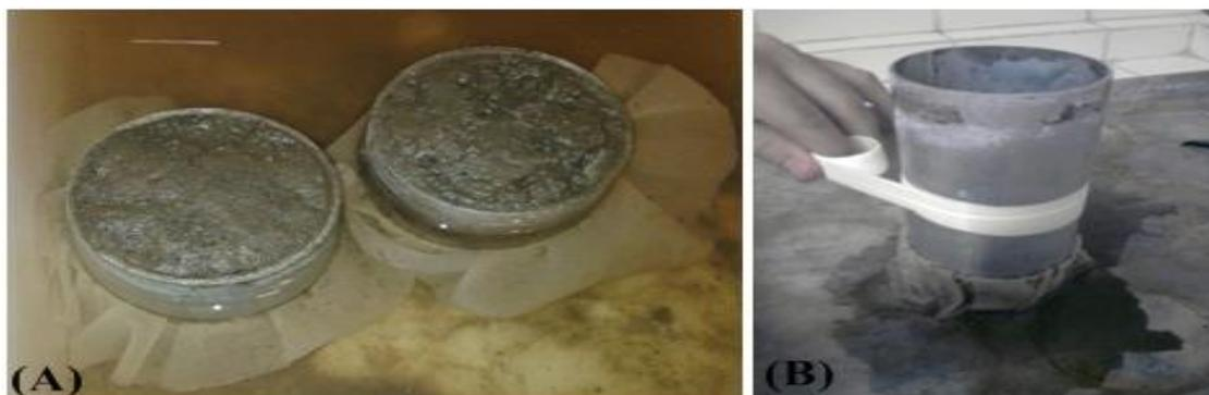
Figura 1 – Amostra sendo saturada (A) e vedação da mesma para ser colocada no permeâmetro de carga constante (B).
